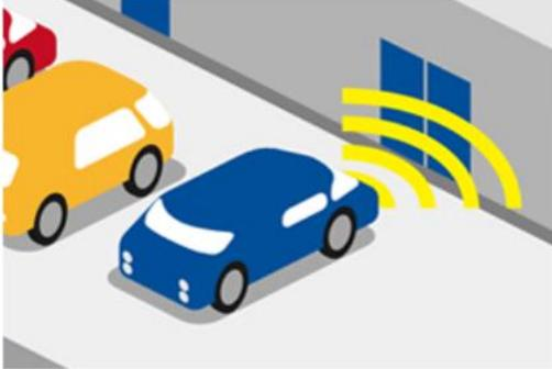
停止時または低速走行時に、車載のレーダー、カメラまたはソナーが前方または後方の壁や車両を検知している状態でアクセルを踏み込んだ場合に、エンジン出力を抑える等により、急加速を防止する装置
