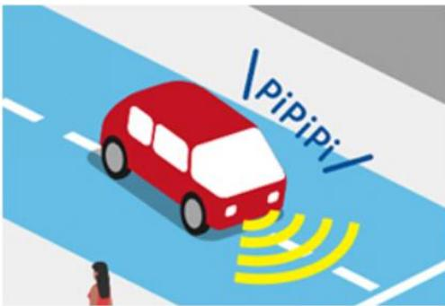
車載のカメラにより道路上の車線を検知し、車線からはみ出し、またはそのおそれがある場合に運転者に対して警報する装置
