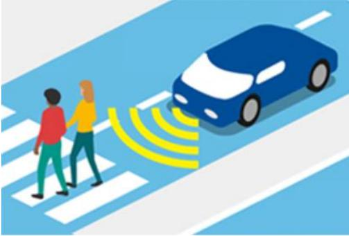
車載のレーダーまたはカメラにより前方の車両、歩行者等を検知し、衝突の可能性がある場合には、運転者に対し警報し、衝突の可能性が高い場合には、自動でブレーキを作動させる装置
